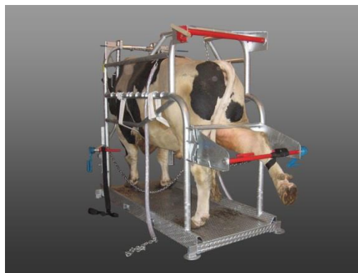
Ryc. 16. Poskromie umożliwia bezpieczne przeprowadzenie korekty racic.
