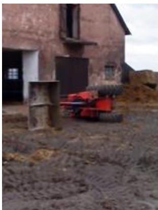
Ryc. 31. Gwałtowne manewry ładowarką prowadzą do jej przewrócenia
