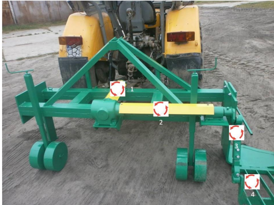
Fot. numer 6 - ilustracyjna: wyorywacz szkółkarski z otrząsaczem o identycznych zasadach działania i podobnej budowie jak ten, uczestniczący w wypadku w dniu 12.10.2022 r. Zaznaczono wszystkie zespoły i części ruchome, które stwarzają zagrożenie dla osób obsługujących tą maszynę. Istnieje duże prawdopodobieństwo, że elementy 3 i 4 będące w ruchu, podobnie jak 1 i 2, nie posiadały również osłon w wyorywaczu użytkowanym w dniu wypadku.
