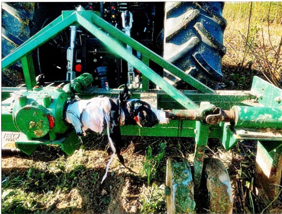
Fot. numer 4. Ciąg przekazu mocy wyorywacza drzewek (ze zmontowanymi prowizorycznie wałkami przekazu mocy zdemontowanymi po wypadku).
