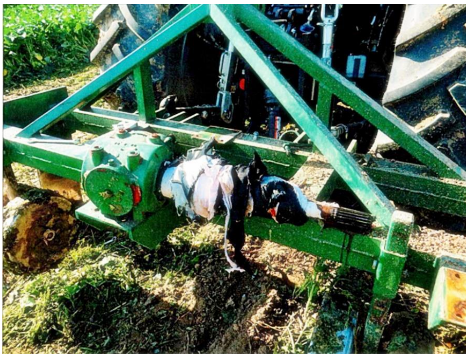
Fot. numer 3. Reduktor wyorywacza drzewek z wałkiem przekazu mocy, który pochwycił poszkodowaną.
