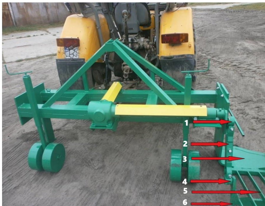
Fot. numer 7. Budowa otrząsacza: 1. Mechanizm korbowy zespołu napędowego 2. łącznik przegubowy - "targaniec" (przegubowe wykonanie łącznika pozwala na opuszczanie i podnoszenie rusztu otrząsacza zapewniając w ten sposób funkcję otrząsającą z nadmiaru ziemi system korzeniowy wyorywanych drzewek) 3. Lemiesz podorujący i wyorujący 4. Przegub kulowy 5. Ruszt otrząsacza 6. Uchwyt otrząsacza z kulą (Fotografia ilustracyjna)
